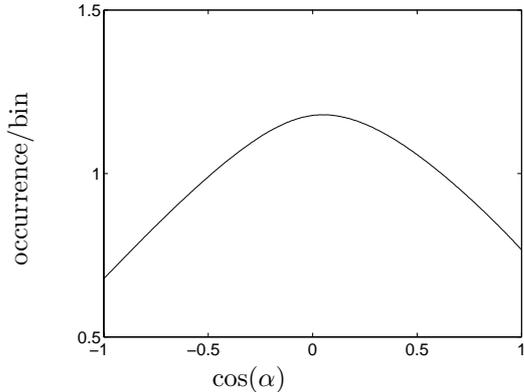
Abbildung 13: Histogramm des Winkels  $\alpha$  zwischen dem kleinskaligen Wirbelstärkevektor  $\boldsymbol{\omega}^{(1)}$  und dem Interaktionsterm  $\boldsymbol{\omega}^{(0)} \cdot \nabla_{\mathbf{x}} \mathbf{u}^{(1)}$ , akkumuliert über 13 zeitlich aufeinanderfolgende Strömungsfelder mit jeweiligem Abstand  $t_{kol}$ .
